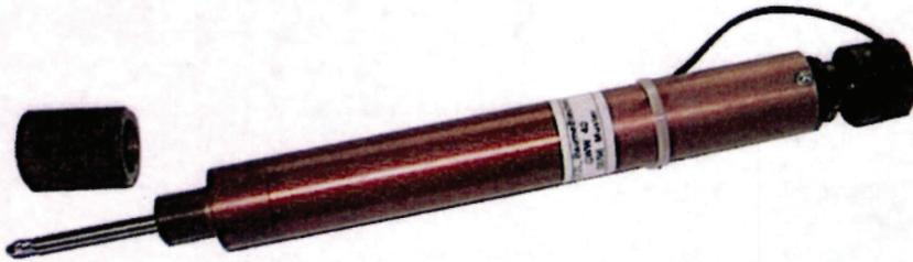
Abbildung 50: Wegaufnehmer Typ GWW 30/40 mit Gewindemuffe für Stangenextensometer [27]
