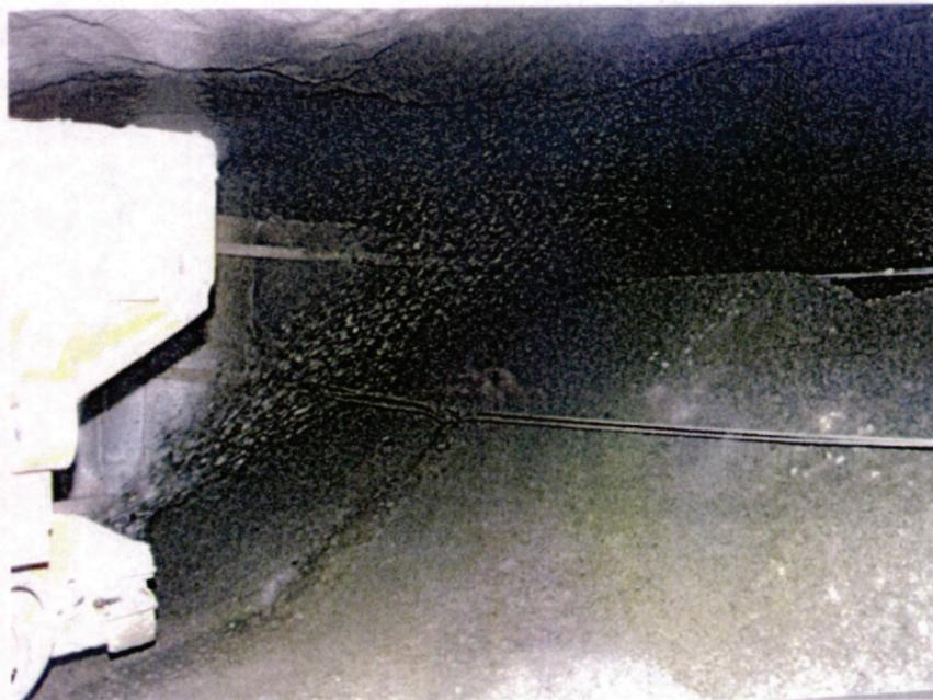
Abbildung 33: Sicherung der Big-Bags mit Stahlseilen [10], ohne Datum
