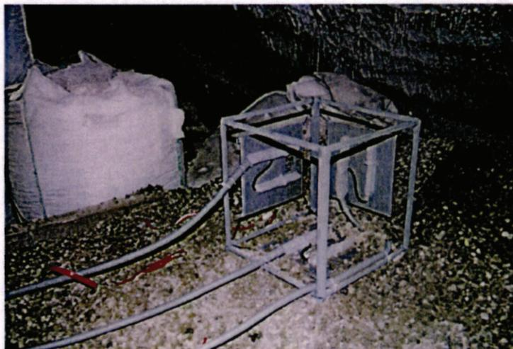
Abbildung 39: Stahlrahmen mit drei hydraulischen Druckkissen [10], Aufnahme von 1997
